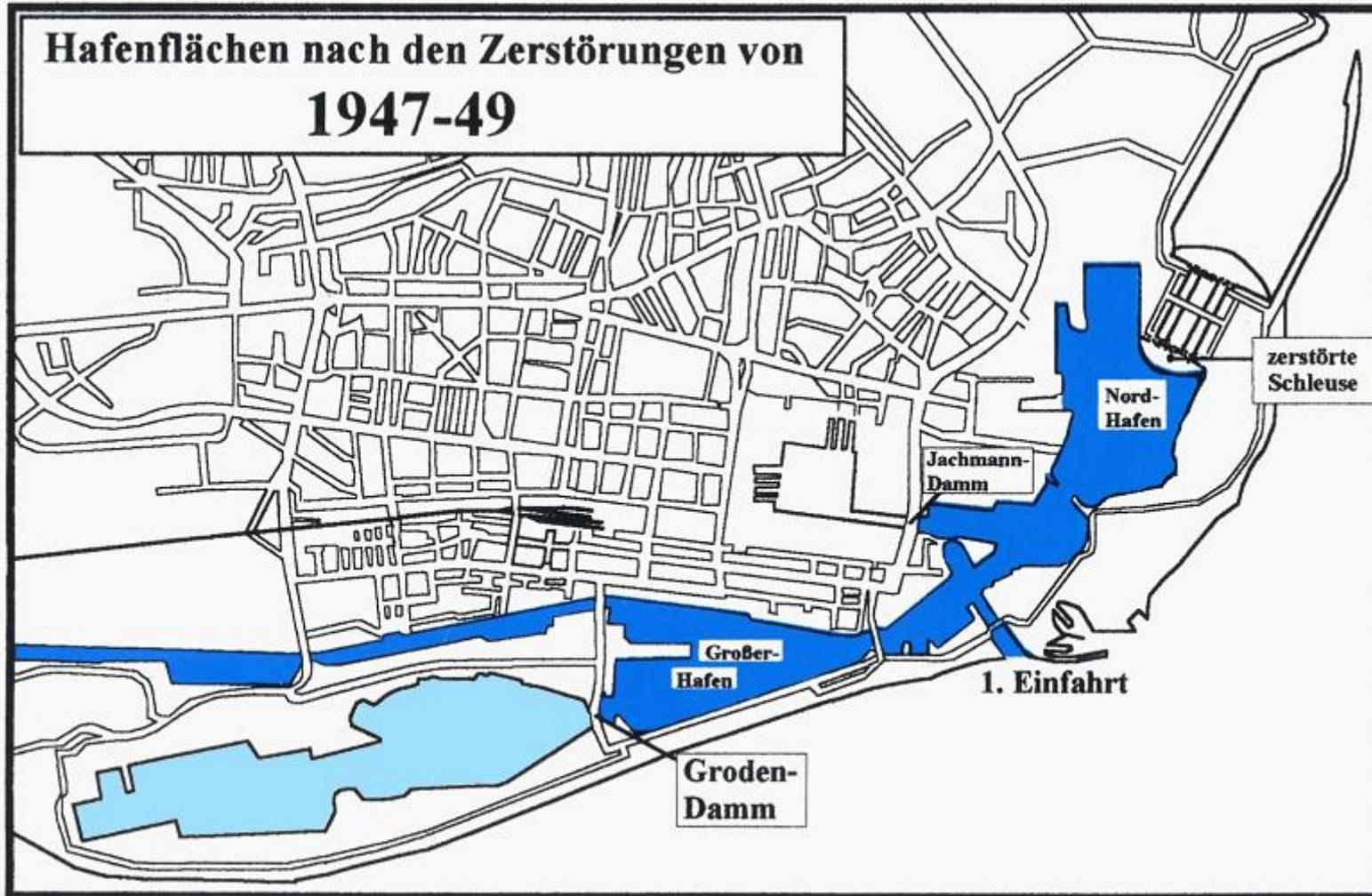
Abb. 5: Die verbliebenen, nutzbaren Hafenflächen nach Zerstörung der Schleusenhäupter sowie Aufschüttung von Jachmann- und Groden-Damm
